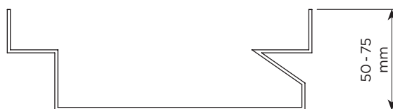
Versão do corpo do canal com altura de 50 a 75 mm
