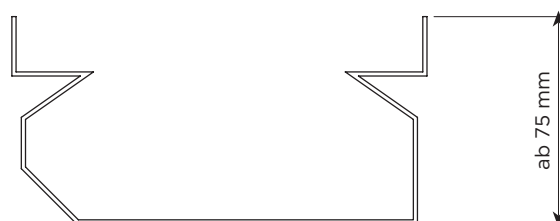
Corpo do canal de 75 mm de altura
